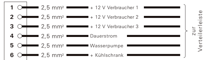
Bild 12: Anschlussplan 6-poliger Steckverbinder
